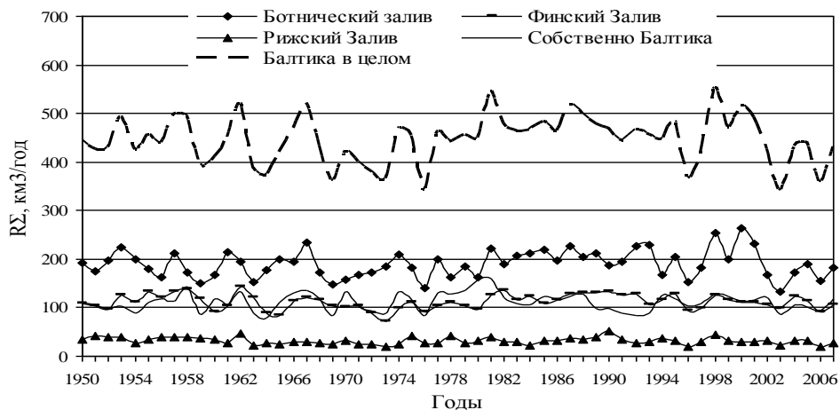
Рис. 1. Межгодовая изменчивость речного стока R_{\Sigma} (км 3 /год) в регионах Балтики за период 1950-2007 гг., рассчитанная по [14]
