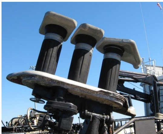
Рис. 1. Неводовыборочная машина «TRIPLEX» с тяговыми барабанами цилиндрической формы, футерованными резиной
