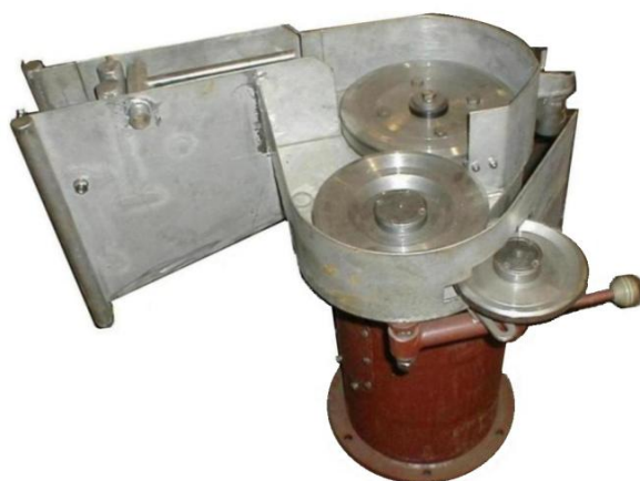
Рис. 2. Лебедка ярусная комплекса «Банга» со стальными тяговыми барабанами клиновидной формы и прижимным роликом
