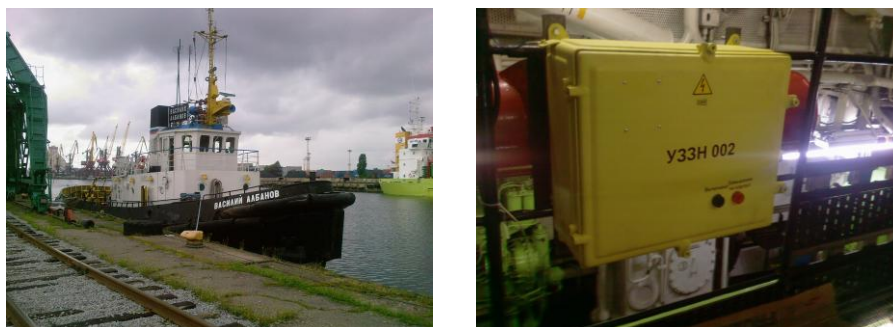
Рис. 2. БК «Василий Албанов» и установленное на его борту устройство защитного заземления нейтрали
