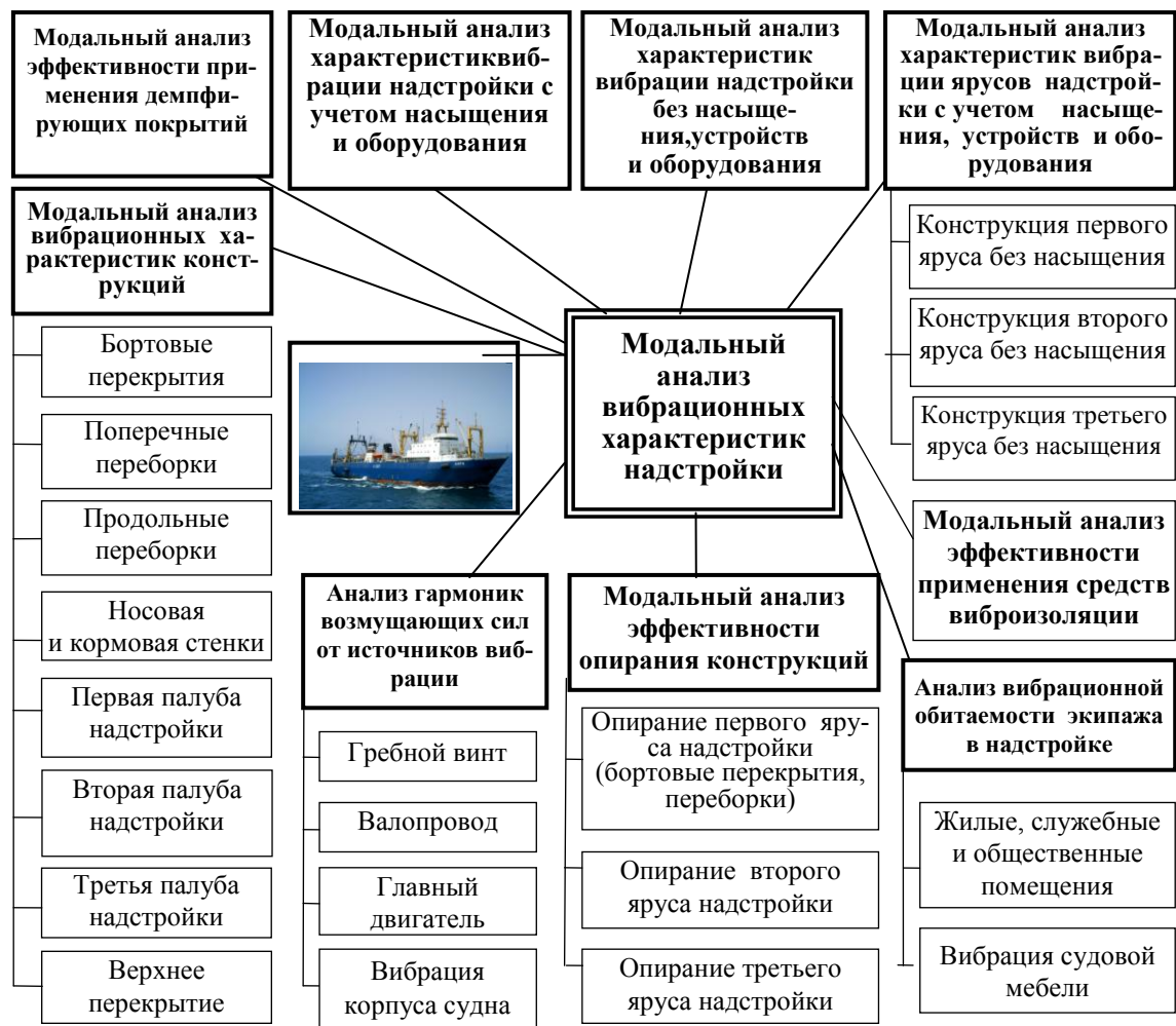
Рис. 1. Структурная схема модального анализа характеристик вибрации надстроек Fig. 1. Block diagram of a modal analysis of the superstructures vibration
