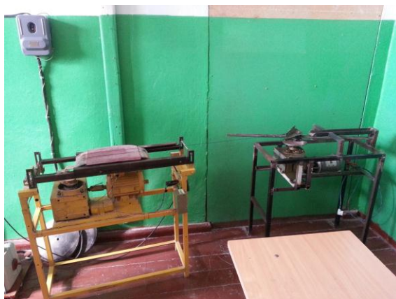
Рис. 1. Экспериментальная установка для исследований абразивного износа Fig. 1. Experimental unit for investigation of abrasive wear
