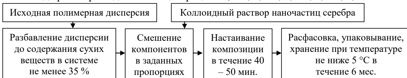
Рисунок 4 – Схема получения модифицированной латексной композиции
