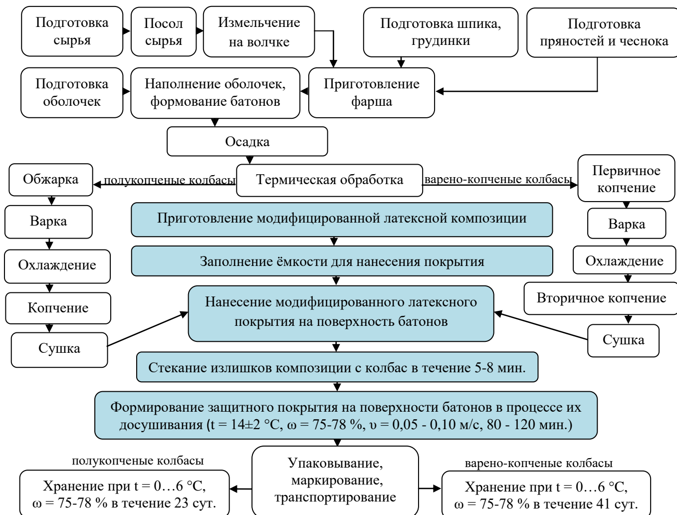
Рисунок 9 – Технологическая схема производства полукопченых и варено-копченых колбас в модифицированном латексном покрытии
