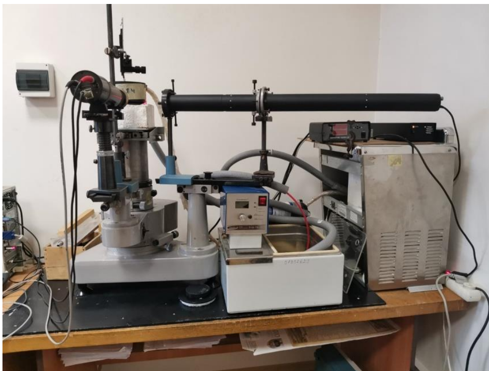
Рисунок 2.3.4 – Экспериментальная установка исследования коэффициента диффузии методом ФКС
