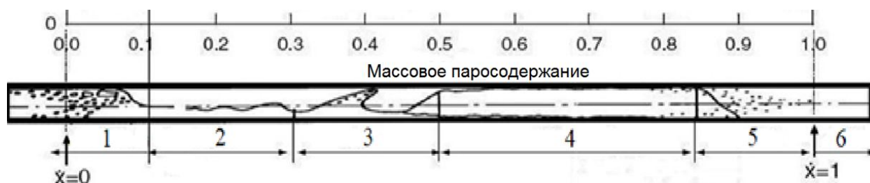
Рисунок 1.1 - Режимы двухфазного потока: 1-пузырьковый, 2-слоисто-волновой, 3-снарядный, 4- кольцевой, 5-дисперсный, 6-зона сухого пара
