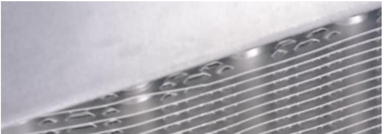
Рисунок 5.8 - Тиснение на алюминиевых ребрах ВО
