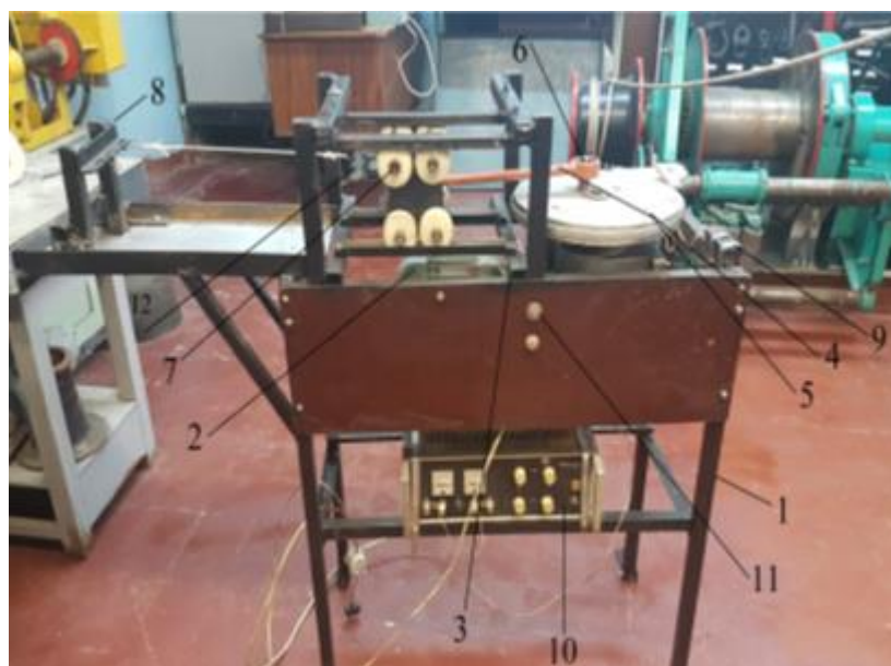
Рисунок 15 - Экспериментальная установка для определения величины износа при циклических нагрузках рыболовных текстильных материалов:
