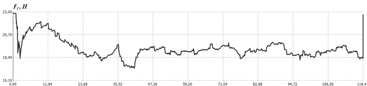
Рисунок 4.17 - Зависимость силы трения нижней подбора о дно водоема от времени
