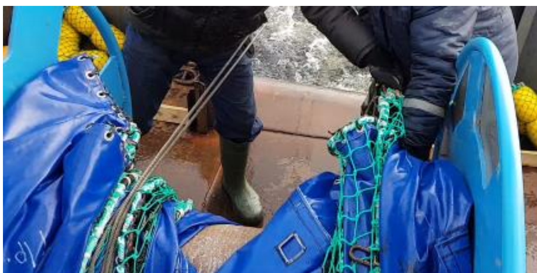
Рисунок 2.20 – Наматывание ГРУ на кабельно-сетной барабан
