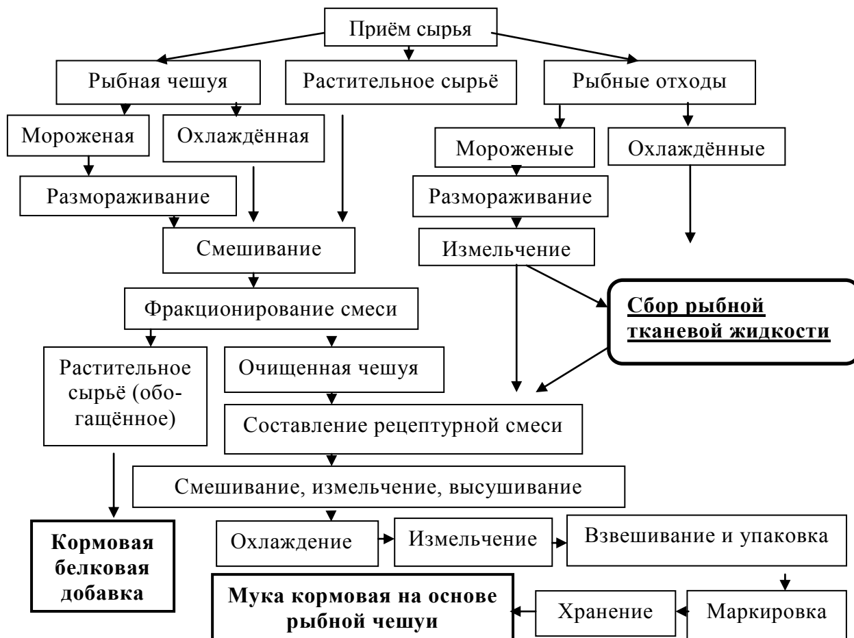
Рисунок 4 – Схема технологического процесса получения муки кормовой на основе рыбной чешуи
