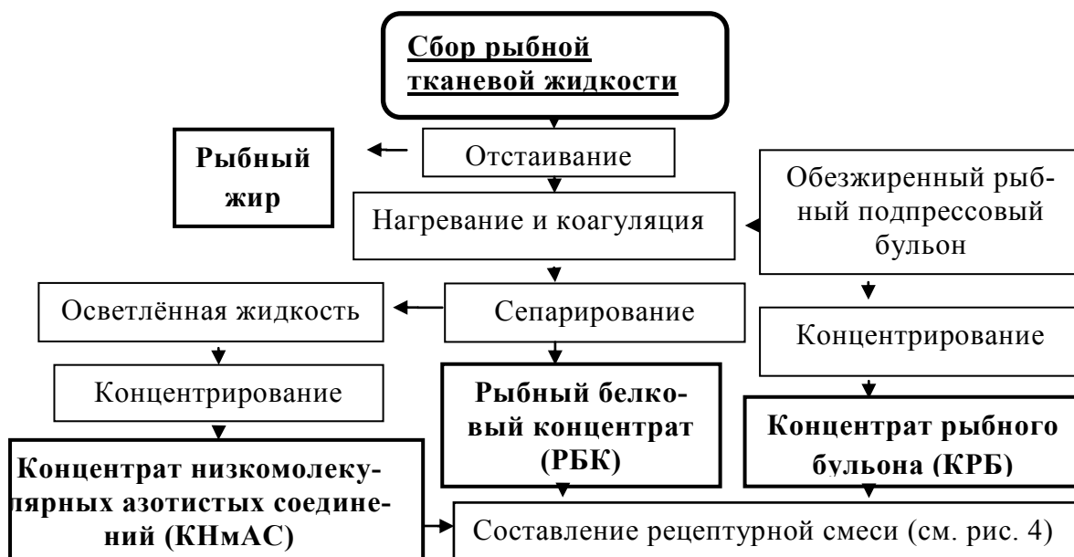
Рисунок 5 – Схема технологического процесса получения муки кормовой на основе рыбной чешуи с использованием обезжиренного рыбного бульона и продуктов его переработки
