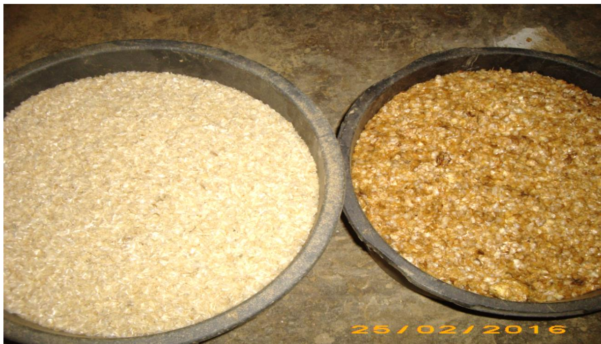
Рисунок 3.8 – Внешний вид высушенных образцов предварительно обработанной способом сухой очистки (слева) и необработанной чешуи сардинеллы (справа) в производственных условиях
