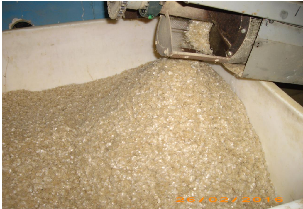
Рисунок 3.9 – Внешний вид чешуи, полученной в производственных условиях способом сухой очистки
