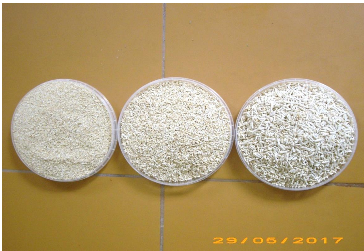
Рисунок 3.7 – Внешний вид (3 фракции) чешуйчатых иголок, получаемых из чешуи в процессе её сухой очистки
