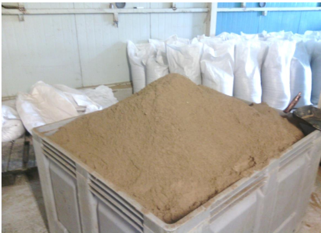
Рисунок 3.19 – Внешний вид муки кормовой на основе рыбной чешуи (с добавлением рыбных отходов), полученной в промышленных условиях
