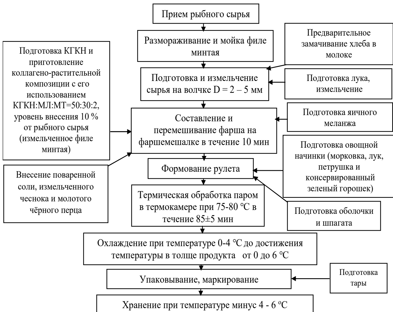
Рисунок 7 – Технологическая схема производства кулинарного рыбного изделия в виде рулета из минтая в оболочки с КРК
