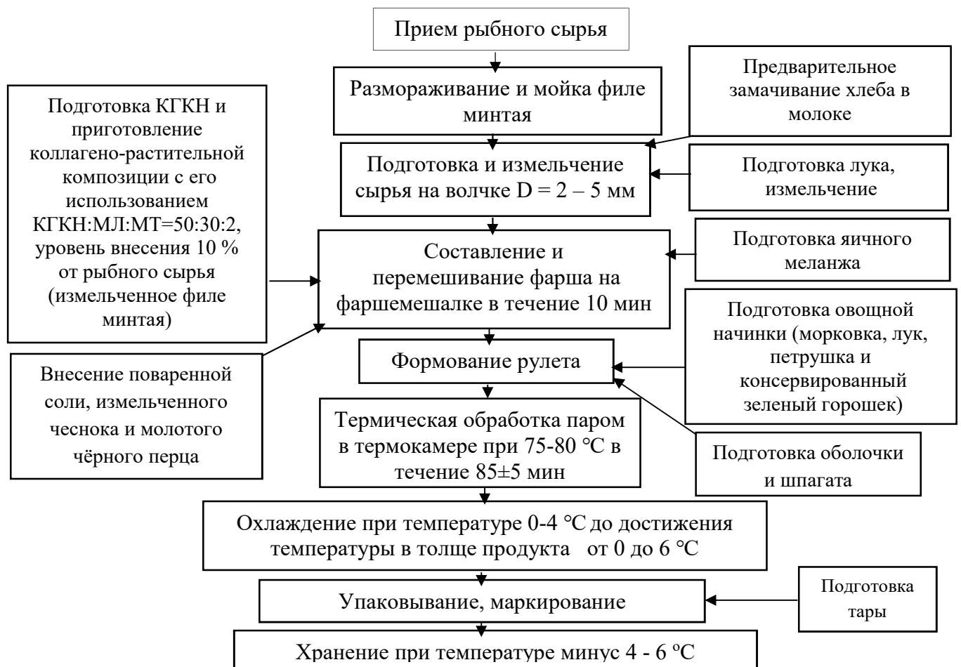
Рисунок 24 – Технологическая схема производства кулинарного рыбного изделия в виде рулета из минтая в оболочке с КРК
