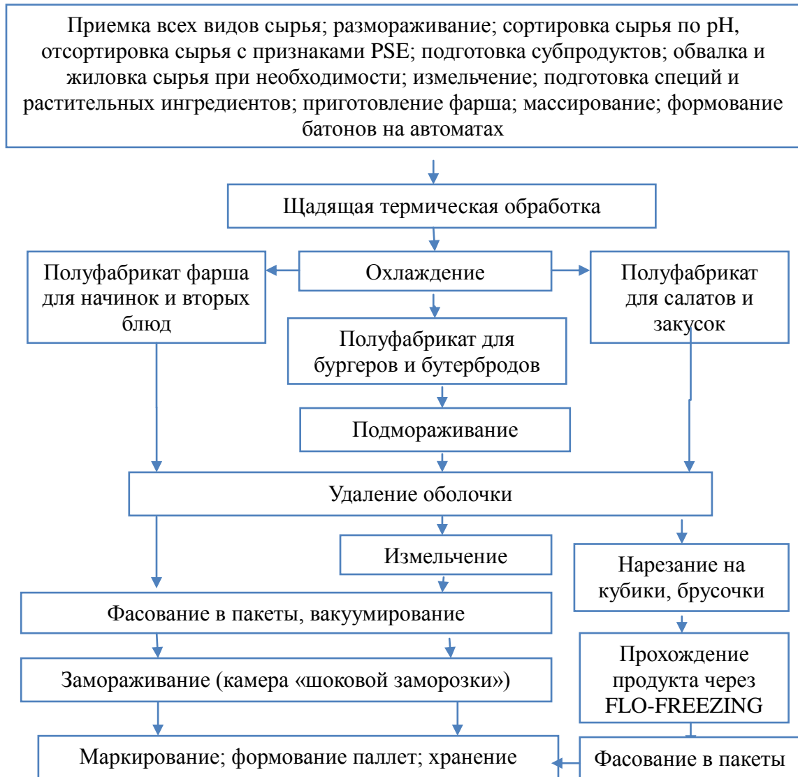
Рис. 3. Технологическая схема производства мясного многокомпонентного полуфабриката высокой степени готовности Fig. 3. Technological scheme for production of a multicomponent manufactured meat product of high readiness
