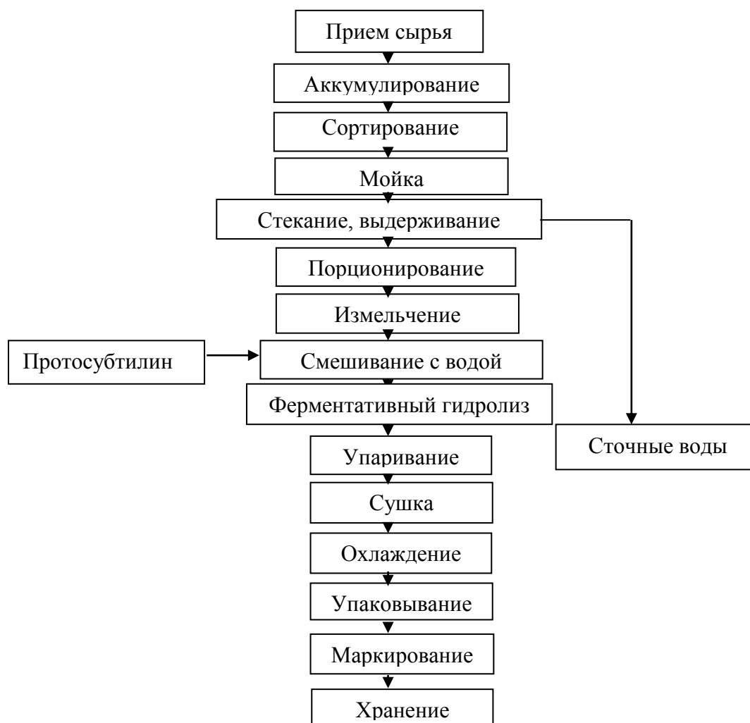
Рис. 4. Технологическая схема получения кормовой добавки способом ферментативного гидролиза
