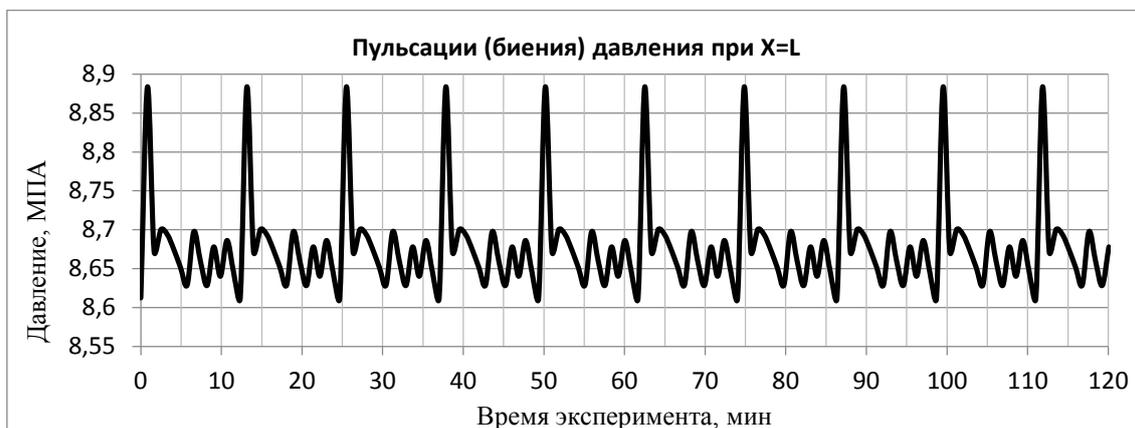
Рис. 8. Давление на движущейся границе фильтрации при  $t > 12,34$  мин
