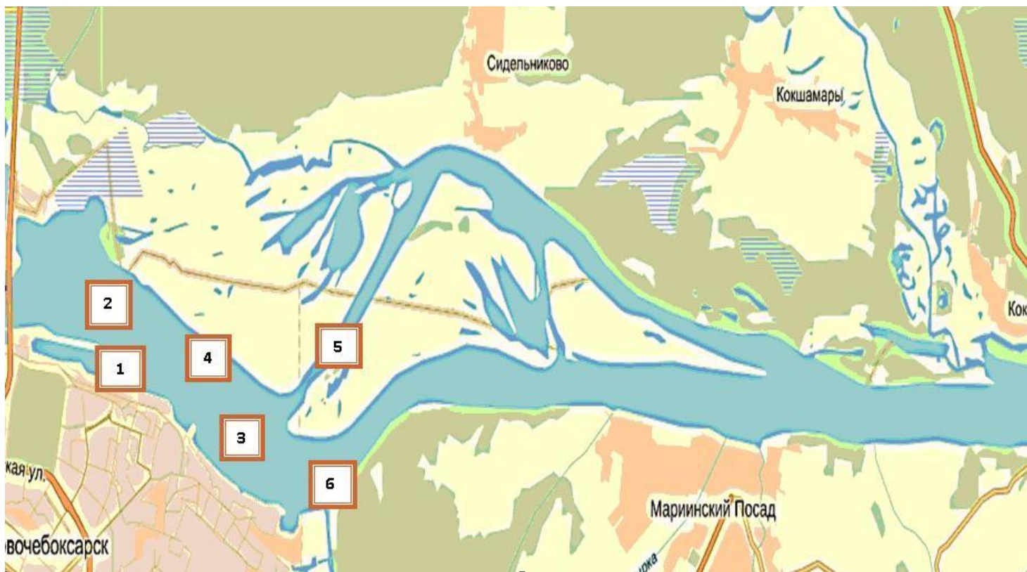
Рис. Карта-схема проведения ихтиологических исследований в целях определения мест локализации рыб, в том числе производителей, а также изучения распределения молоди рыб в нижнем бьефе Чебоксарского гидроузла ГЭС: участок № 1 – у нижнего подходного канала судового шлюза; участок № 2 – зона воздействия гидроагрегатов и водопропускных сооружений; участок № 3 – правобережье на 1190-1191 км судового хода; участок № 4 – левобережное мелководье; участок № 5 – пойма рукава Старая Волга; участок № 6 – русло в районе впадения р. Цивиль
