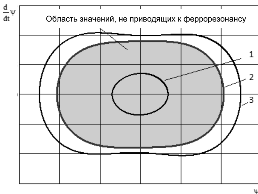
Рис. 2. Решения уравнения Дуффинга в фазовых координатах: 1 - нерезонансные колебания; 2 – неустойчивое равновесие; 3 – феррорезонансные колебания
