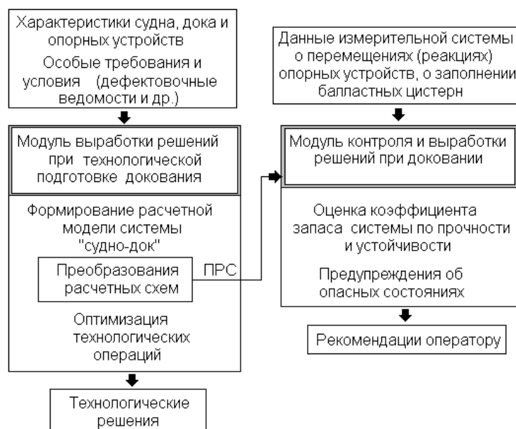
Рис. 1. Функциональное назначение модулей подсистемы инженерного анализа Fig. 1. Functional area of the engineering analysis subsystem modules
