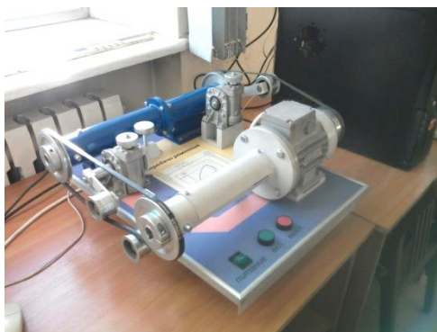
Рис. 5. Лабораторная установка с возможностью изменения угла охвата гибким элементом твердого тела нагружающей передачи
