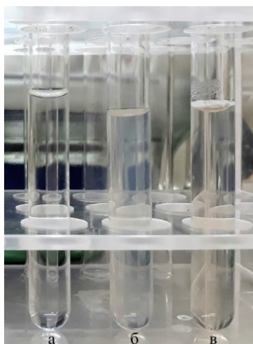
Рис. 5. Дистиллированная вода (а) и гидрогели 0,85%-ного раствора агара из A. tobuchiensis (б) и A. plicata (в)
