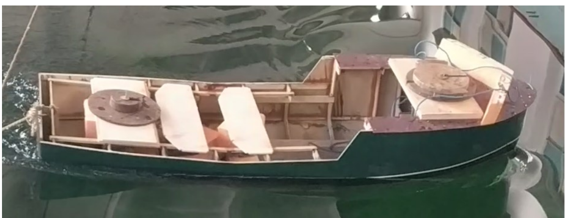
Рис. 6. Испытание модели при скорости буксировки 5 уз Fig. 6. Model test at a towing speed of 5 knots
