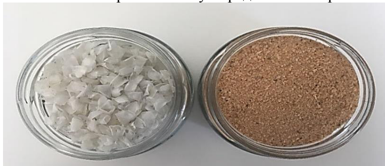
Рис. 2. Внешний вид исходной высушенной чешуи (слева) и термически гидролизованной в яблочном соке прямого отжима высушенной и измельченной рыбьей чешуи (справа)
