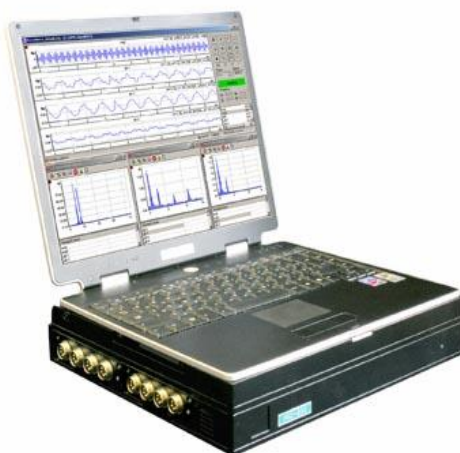
Рис. 6. Тензометрическая станция MIC-200 Fig. 6. Tenometric station MIC-200
