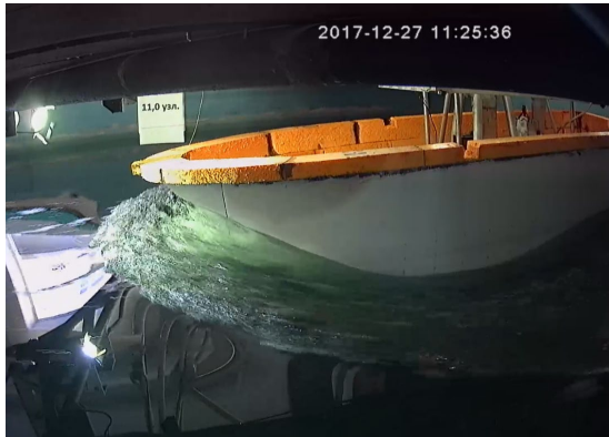
Рис. 6. Испытания МРКТ «Адомат». Ровный киль, скорость 11 узлов
