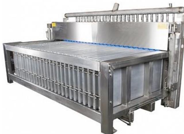
Рисунок 13. Контактный испаритель. Группа 3.
