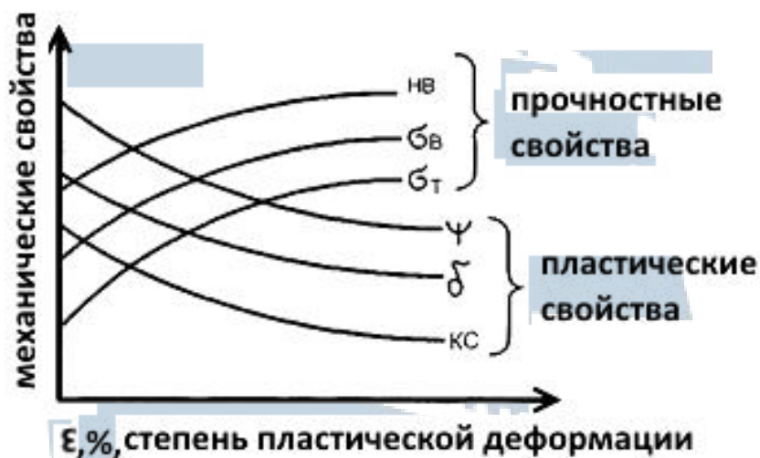
Рис. 2.5. Влияние степени деформации на механические свойства металла
