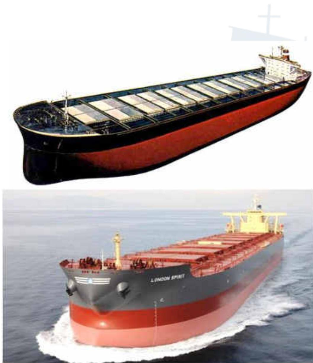
Суда для навалочных грузов (рис. 2.7) – балкеры или балкериеры – относятся к разновидности универсальных судов и предназначены для перевозки массовых насыпных грузов: руды и рудных концентратов, угля, зерна, химических удобрений, цемента, сахара-сырца, серы, соли или навалочных грузов: металлолома, труб, стальных заготовок, профильного и листового проката.
