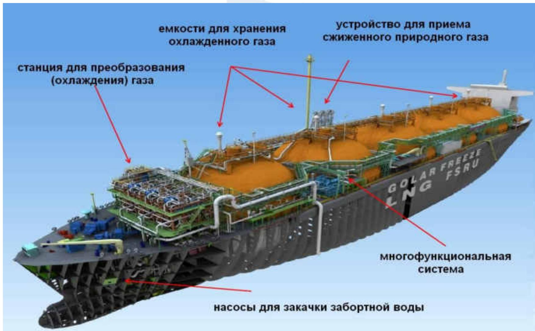
Рис. 2.36. Схема систем газовоза
