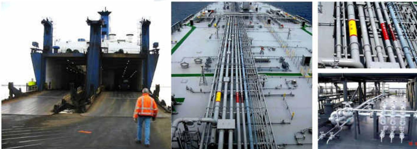
Рис. 6.8. Грузовые устройства в виде аппарелей и трубопроводов на танкерах
