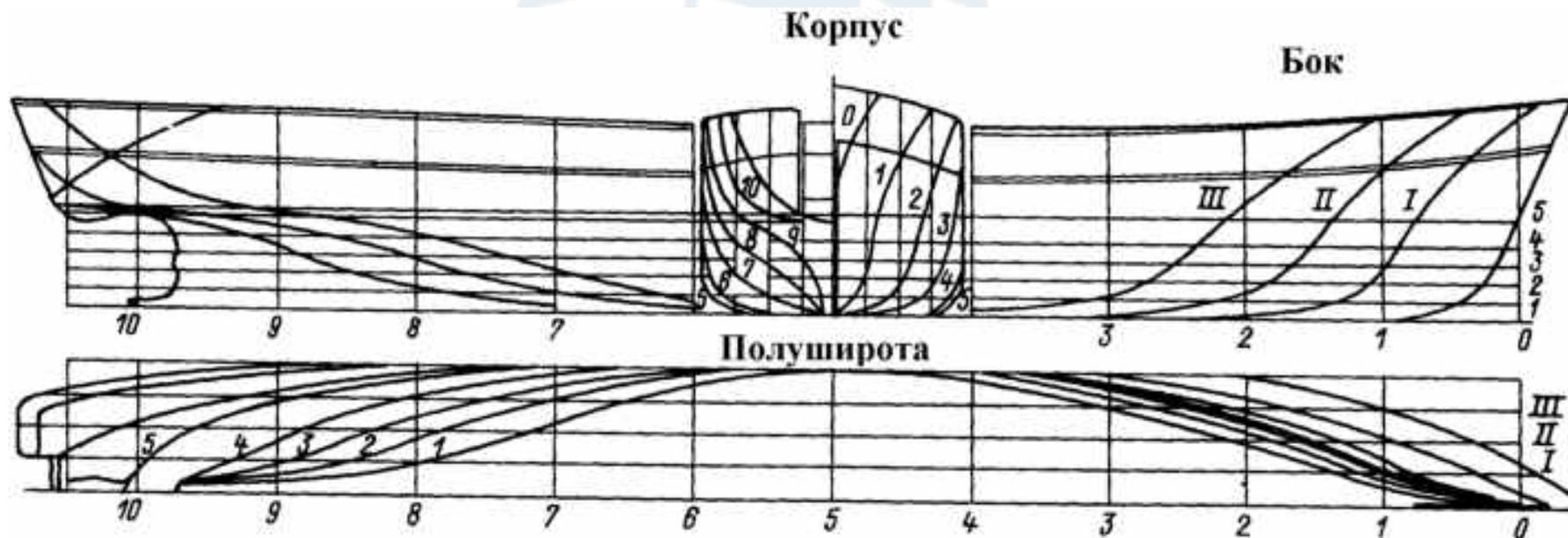
Рис. 3.3. Теоретический чертеж корпуса судна
