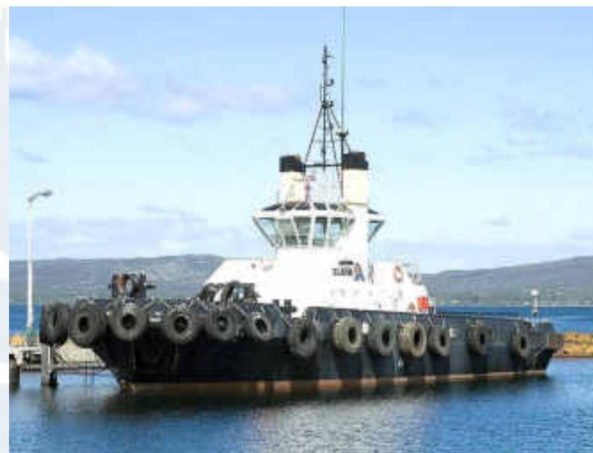
Рис. 6.26. Кранцевая защита на судах
