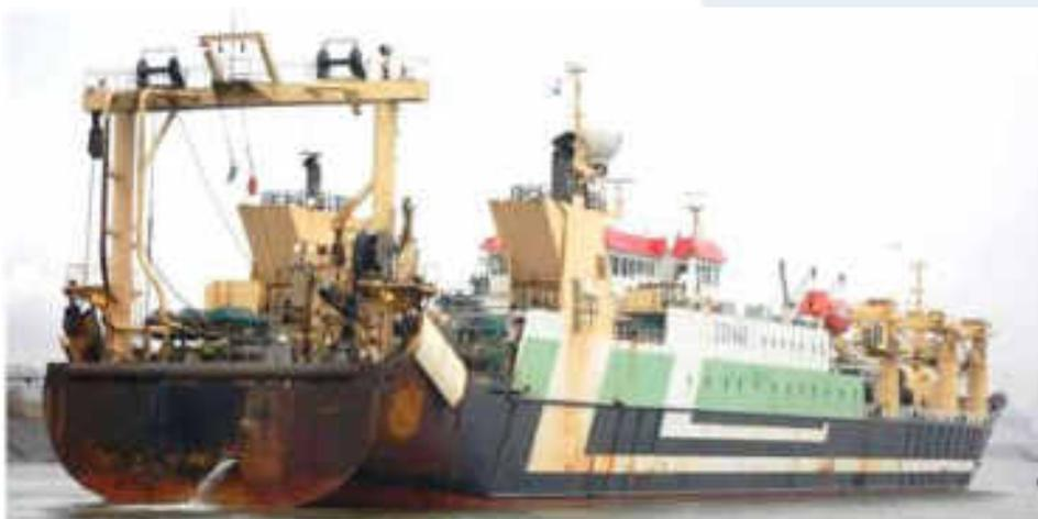
*Траулеры* – наиболее распространенный класс добывающих судов, предназначенных для лова рыбы донными и разноглубинными пелагическими тралами (рис. 2.48).
