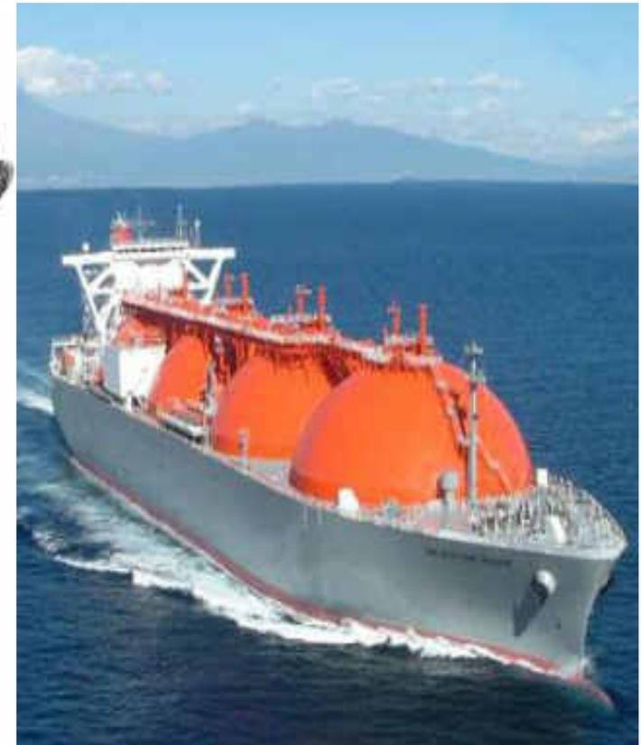
Рис. 2.33. Судно для перевозки сжиженных газов (газовоз):
