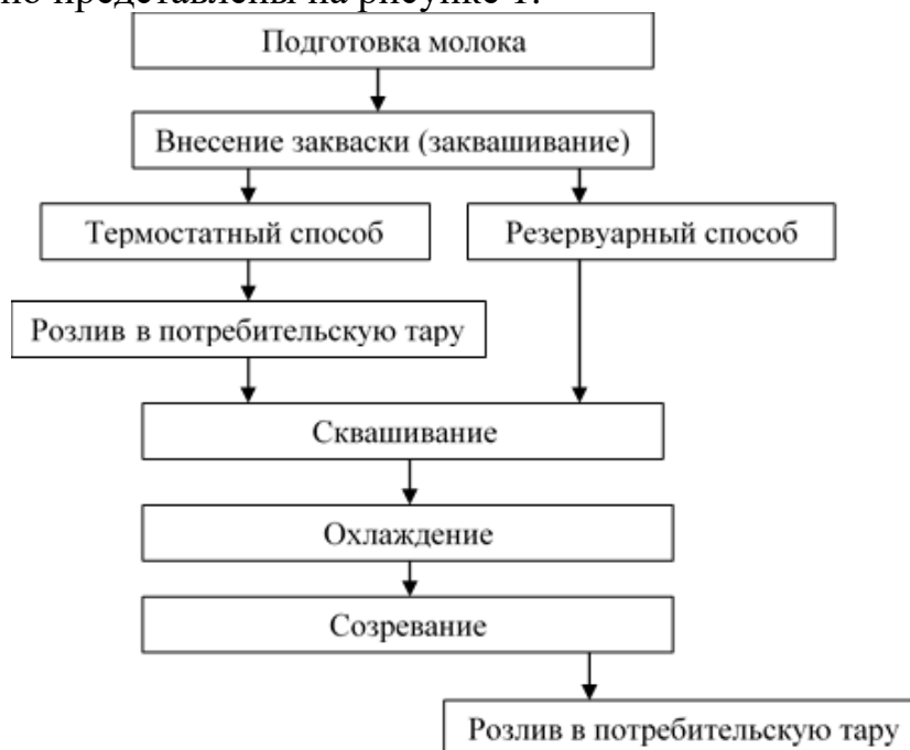
Рисунок 1 – Технологическая схема производства жидких кисломолочных продуктов
