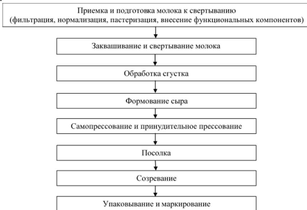
Рис. 2 – Технологическая схема производства сыров
