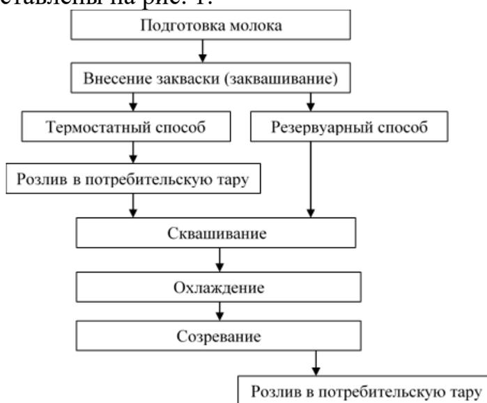
Рис. 1 – Технологическая схема производства жидких кисломолочных продуктов
