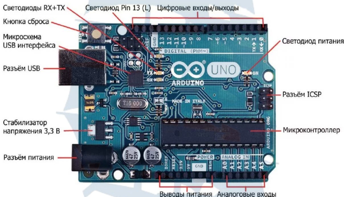
Рис. 1. Внешний вид одноплатной ЭВМ «Arduino Uno»
