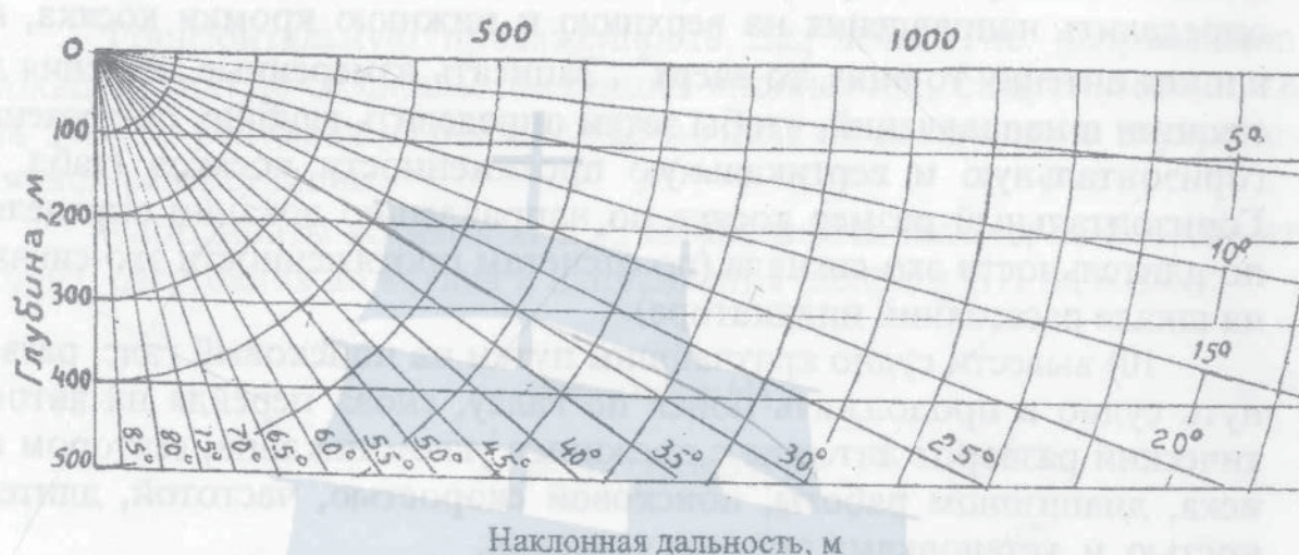
Рис. 6. Зависимость угла наклона антенны от наклонной дальности до косяка и глубины его погружения
