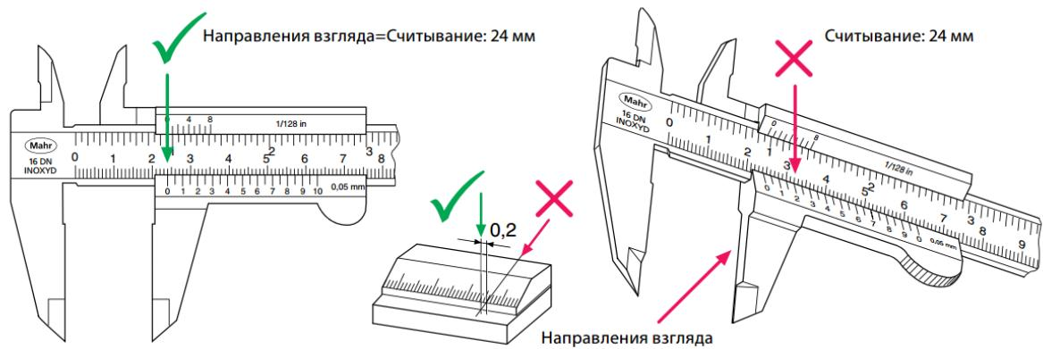
Рисунок 4. Ошибка параллакса при считывании показаний шкал
