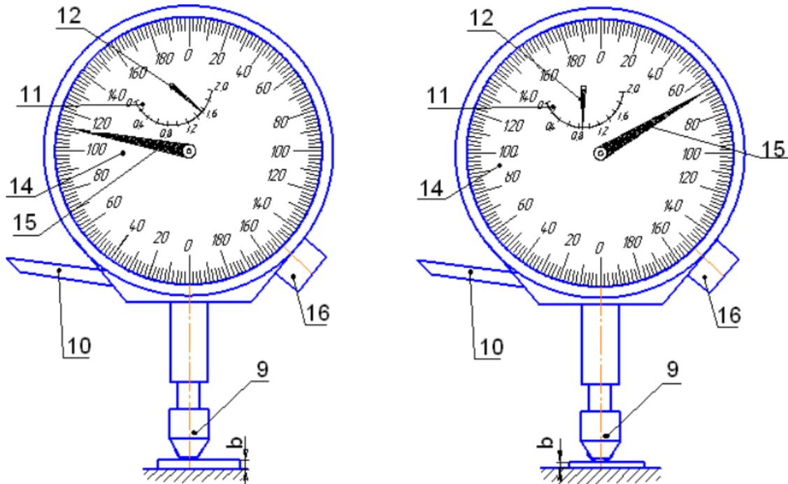
Рисунок 48. Пример снятия отсчёта со шкалы многооборотного индикатора
