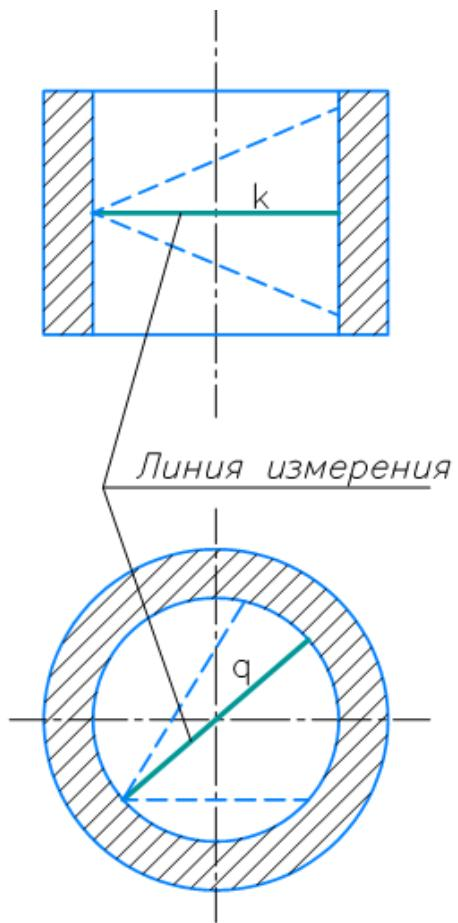
Рисунок 35. Положение линии измерения диаметра отверстия нутромером
