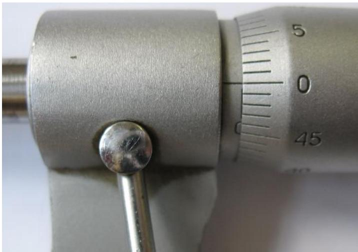
Рисунок 24. Установка микрометра на нуль проведена правильно
