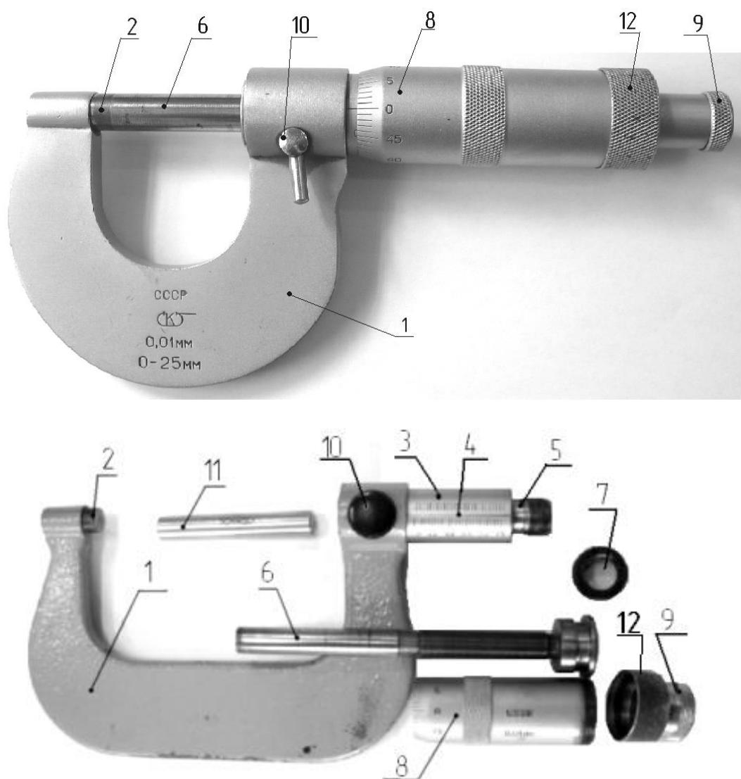
Рисунок 21. Гладкий микрометр типа МК:
