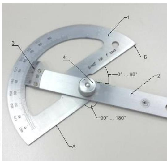
Рисунок 16. Угломер (тип 4):
