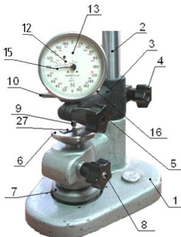
Рисунок 50. Проверка многооборотного индикатора типа 2-МИГ с помощью концевых мер длины: 1 – основание; 2 – колонка; 3 – кронштейн; 4, 5, 8 – стопоры; 6 – измерительный столик; 7 – гайка; 9 – измерительный наконечник; 10 – арретир; 13 – измерительная головка; 16 – винт регулировки положения стрелки 15; 27 – концевая мера
