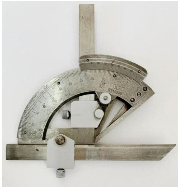
Рисунок 14. Угломер (тип 2):
