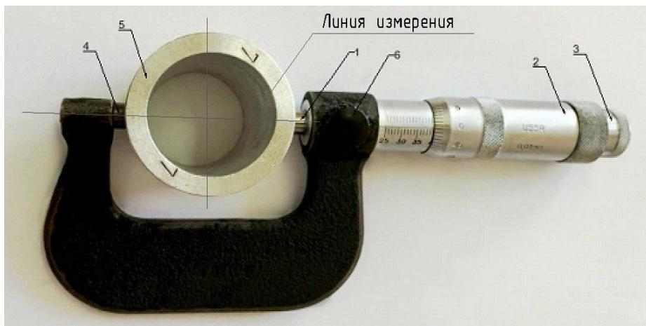
Рисунок 28. Измерение микрометром наружного диаметра втулки:
