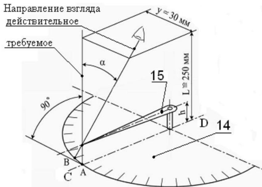
Рисунок 49. Схема, поясняющая появление погрешности от параллакса
