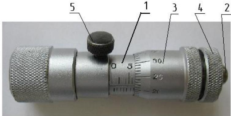
Рисунок 31. Микрометрическая головка нутромера:
