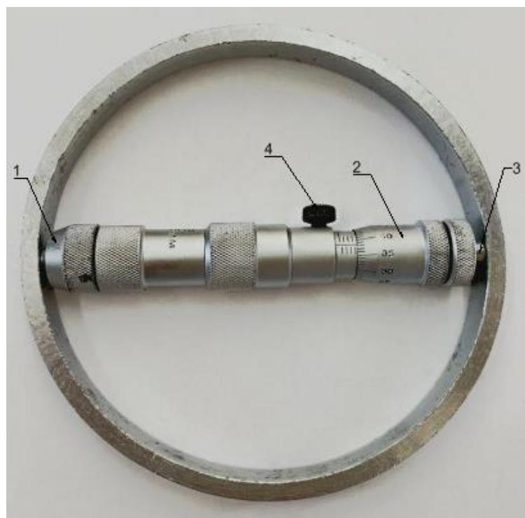
Рисунок 36. Измерение микрометрическим нутромером диаметра отверстия:
