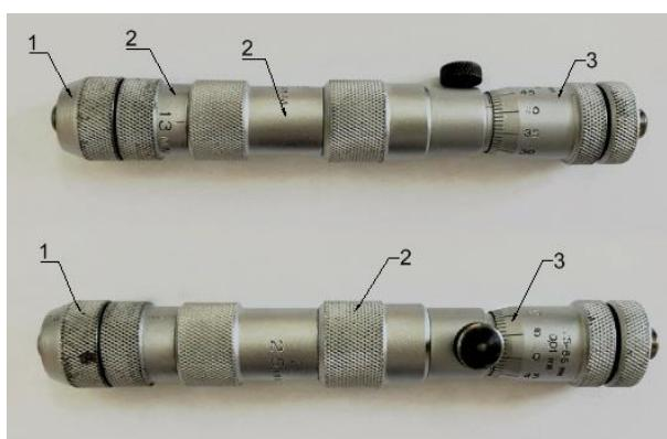
Рисунок 30. Микрометрические нутромеры:
