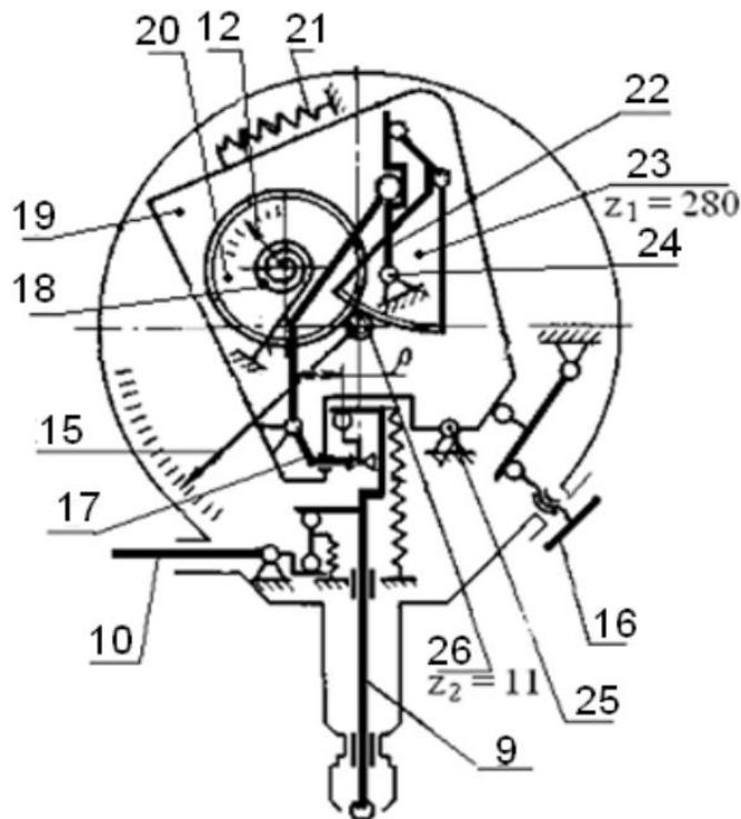
Рисунок 47. Схема многооборотного индикатора типа 2-МИГ:
