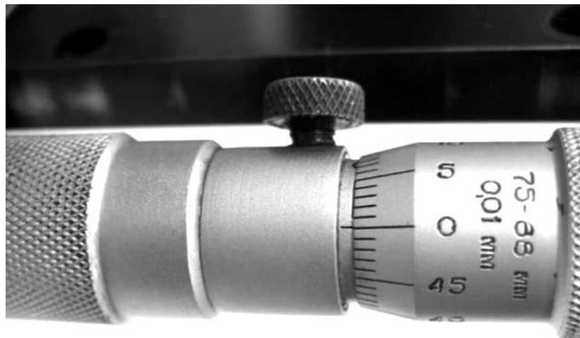
Рисунок 34. Пример правильной установки нутромера на нуль
