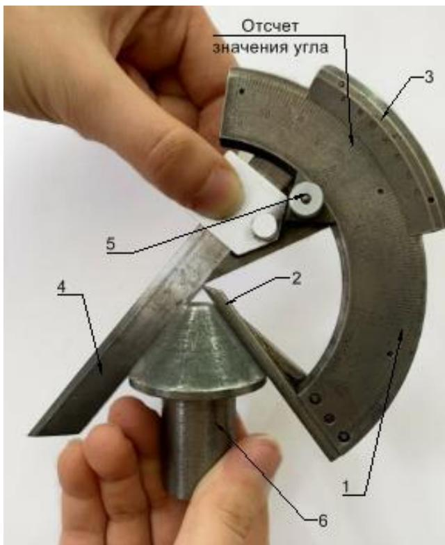
Рисунок 17. Схема измерения угломером:
