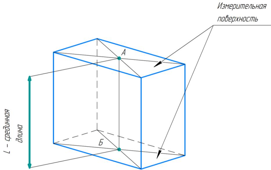
Рисунок 44. Определение срединной длины концевой меры
