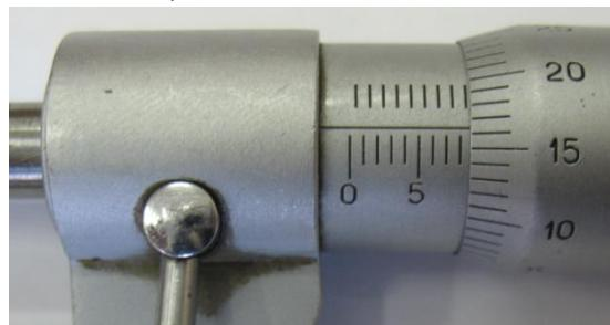
Рисунок 20. Примеры отсчёта размеров при измерении микрометрическими средствами измерений:
