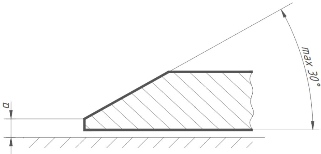
Рисунок 5. Расположение плоскости шкалы нониуса относительно плоскости шкалы штанги
