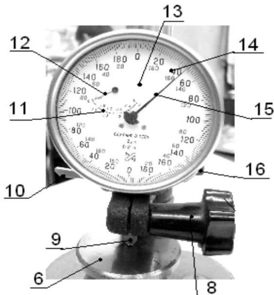
Рисунок 46. Внешний вид многооборотного индикатора типа 2-МИГ:
