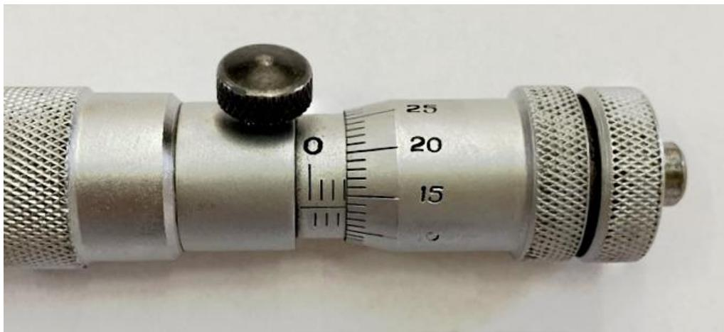
Рисунок 37. Пример отсчёта по шкалам нутромера
