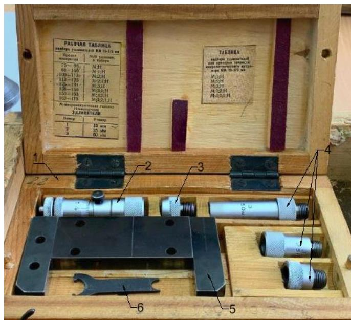
Рисунок 32. Нутромер микрометрический в футляре:
