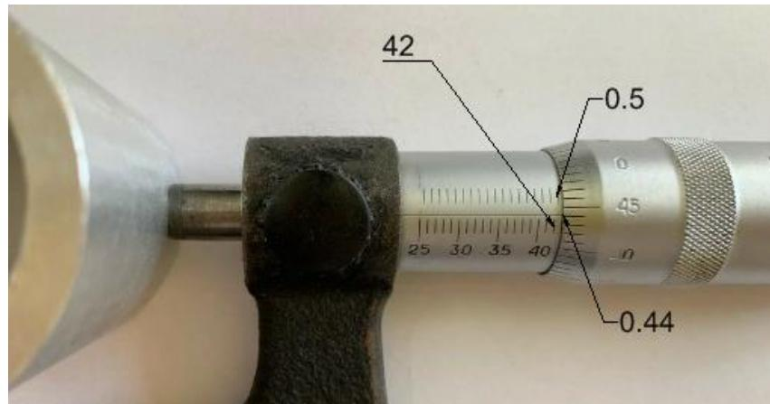
Рисунок 29. Снятие отсчёта по шкалам микрометра:
