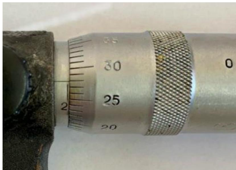
Рисунок 25. Неправильная установка микрометра в нулевое положение
