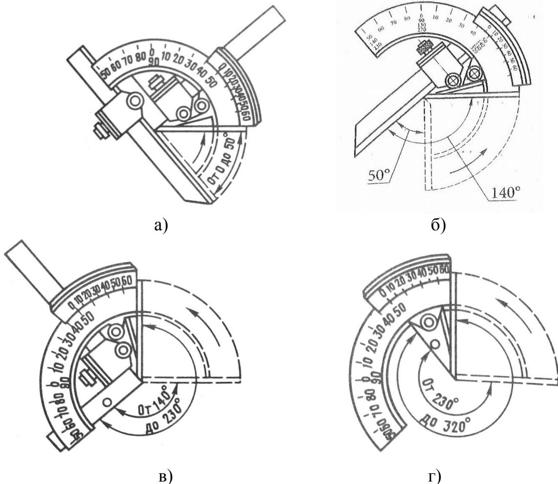
Рисунок 15. Компоновки угломера для измерения углов разных диапазонов:
