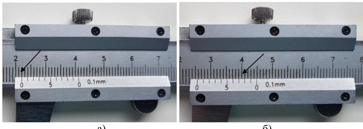
Рисунок 3. Отсчет по нониусной шкале: а) 22 мм, б) 25,8 мм
