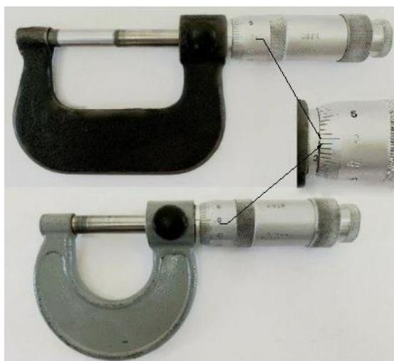
Рисунок 23. Проверка нулевого положения микрометра
