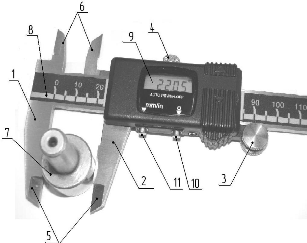
Рисунок 41. Штангенциркуль с электронным отсчётым устройством типа ШЦЦ:
