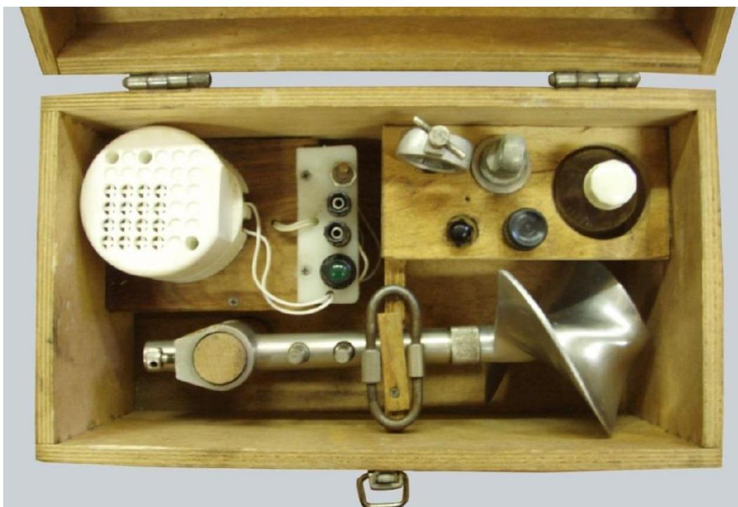
Рис. 5.1. Гидрометрическая вертушка ГР-21М
