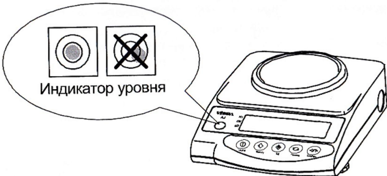
Рис. 1.1. Электронные весы AJ-620CE. Установка уровня
