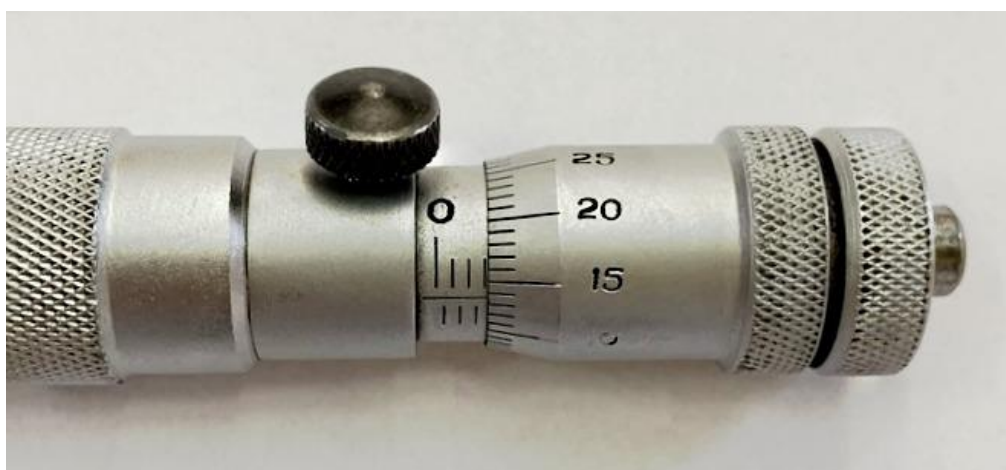
Рисунок 37. Пример отсчёта по шкалам нутромера
