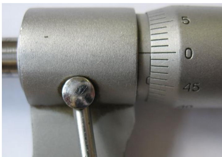
Рисунок 24. Установка микрометра на нуль проведена правильно
