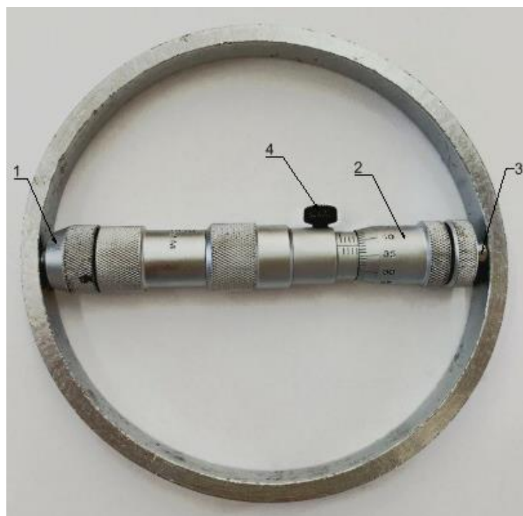
Рисунок 36. Измерение микрометрическим нутромером диаметра отверстия: 1 – наконечник; 2 – барабан; 3 – микровинт; 4 – винт стопорный
