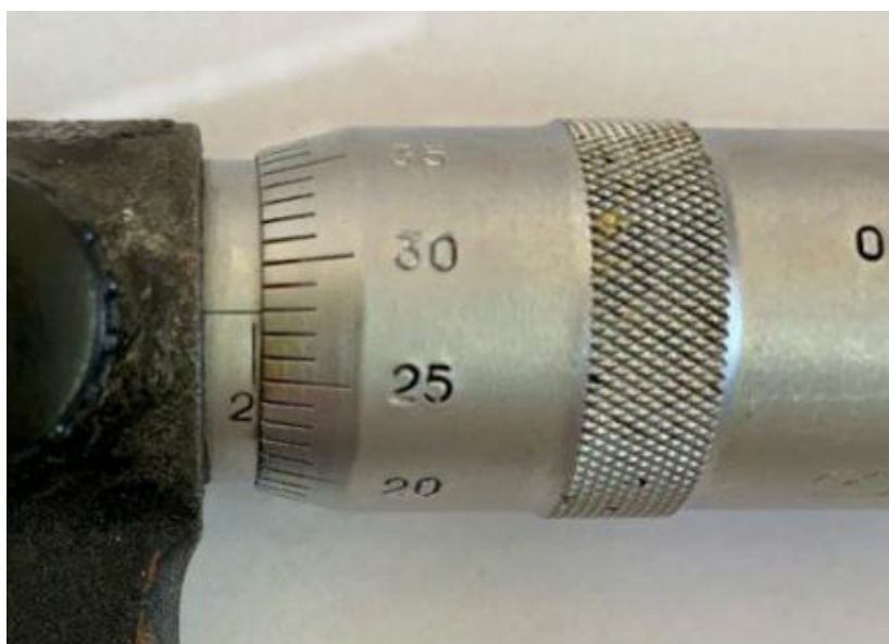
Рисунок 25. Неправильная установка микрометра в нулевое положение
