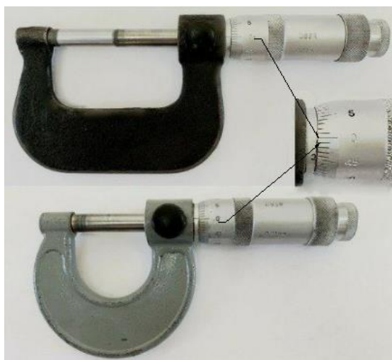
Рисунок 23. Проверка нулевого положения микрометра
