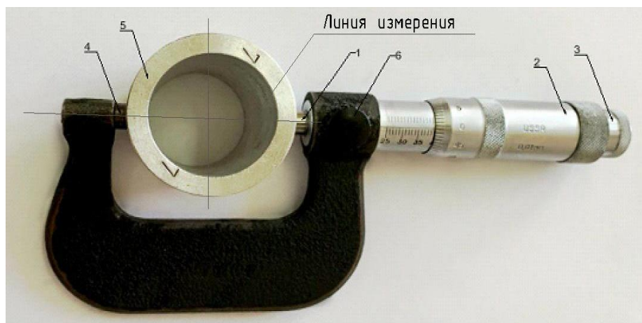
Рисунок 28. Измерение микрометром наружного диаметра втулки:
