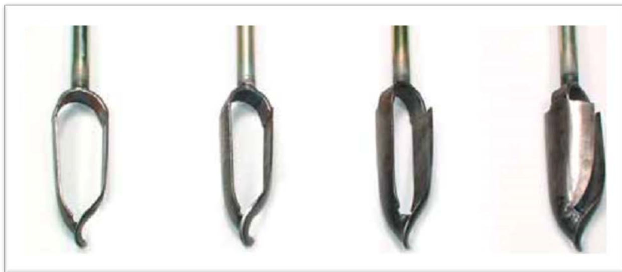
Рисунок 4.1 – Почвенные буры Эдельмана: для глин, для комбинированных почв, для песчаных почв, для крупнозернистых песков
