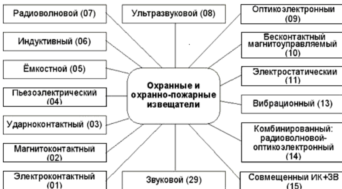
Рис. 40. Принципы действия охранных и охранно-пожарных извещателей
