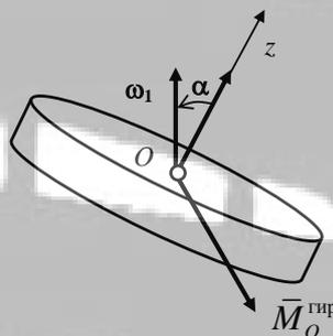
Если расстояние между опорами равно  $h$ , то модули гироскопических давлений  $N^{гир}$  на опоры можно определить по формуле
