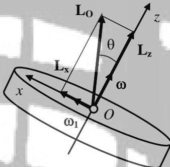
Угол  $\theta$  между главным моментом количества движения  $L_O$  и осью  $z$  симметрии гироскопа определится равенством
