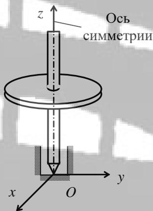
Рассмотрим сначала случай, когда гироскоп движется около неподвижной точки. Если выбрать начало координат в этой точке  $O$  и направить ось  $z$  по оси симметрии гироскопа, то оси  $x$ ,  $y$ ,  $z$  оказываются главными осями инерции гироскопа в неподвижной точке. Момент инерции  $I_z$  является полярным моментом инерции гироскопа, а  $I_x$  и  $I_y$  – экваториальными моментами инерции. В связи с наличием в твердом теле оси симметрии имеем  $I_x = I_y$ .
