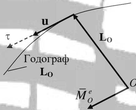
Основное свойство гироскопа с тремя степенями свободы в случае, когда главный момент внешних сил  $\bar{M}_O^e$  относительно неподвижной точки равен нулю, заключается в сохранении неизменного направления оси гироскопа по отношению к инерциальным осям.
