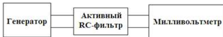
Рисунок 3.13 – Блок-схема лабораторной установки для измерения АЧХ фильтра
