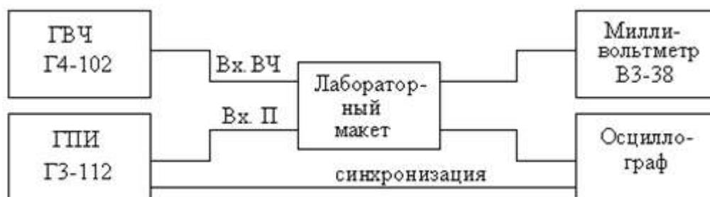
Рисунок 3.10 – Функциональная схема лабораторной установки
