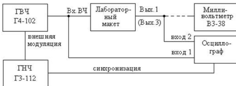
Рисунок 3.11 – Функциональная схема лабораторной установки
