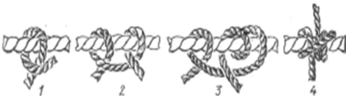
Рис. 57. Вязка выбленочного узла со шлагом
