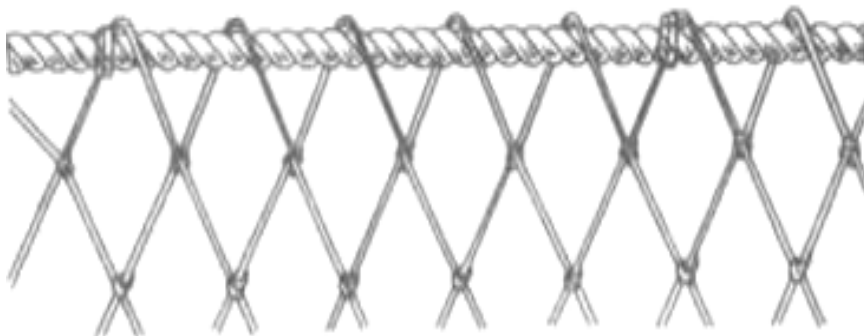
Рис. 56. Нанизывание ячей на подбору
