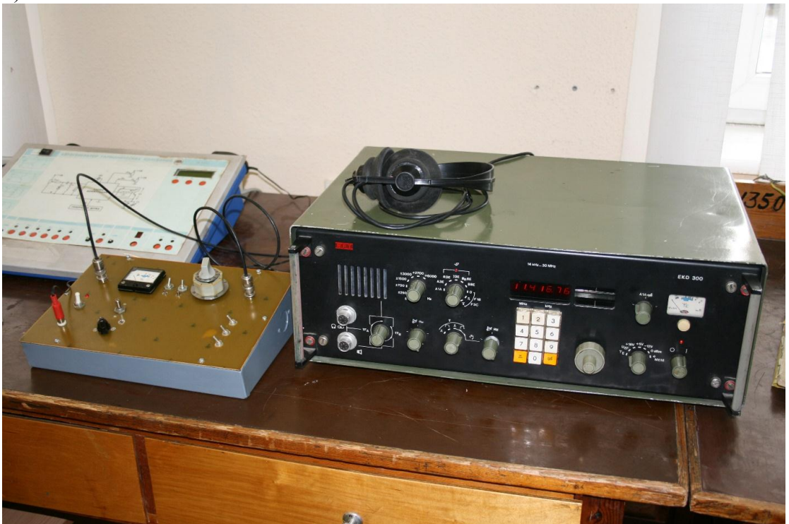
Рисунок 4 – Лабораторные установки: а) РПУ «Бригантина» и измерительный прибор, б) РПУ «ЕКД-300» и измерительный прибор
