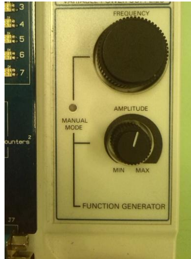
Рисунок 15 – Рукоятки регулировки частоты и амплитуды выходного сигнала
