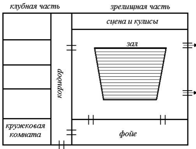
Рисунок 6 – Комбинированная схема (зально-коридорная) здания клуба
