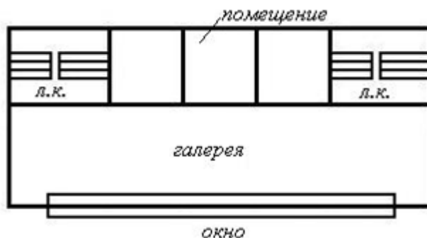
Рисунок 1 – Галерейная планировочная схема
