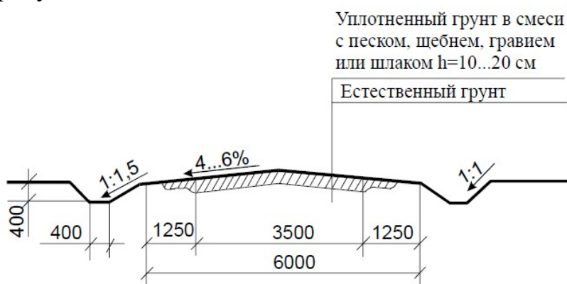
Рисунок 3.1 - Профиль временной дороги с улучшенным покрытием
