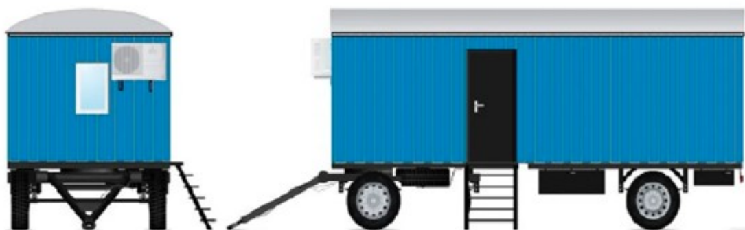
Рисунок 4.3 - Общий вид мобильного двухосного здания со съемным шасси
