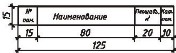
Рисунок 20 - Экспликация помещений плана этажа
