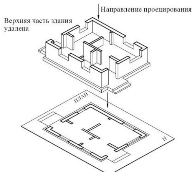
Рисунок 18 - Схема образования плана
