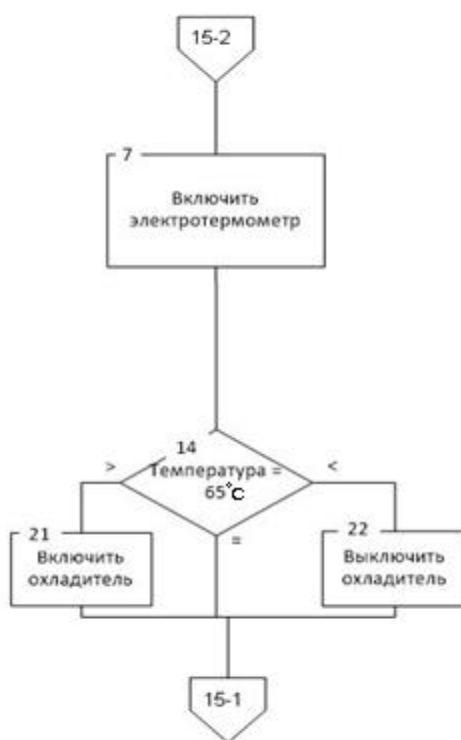
Рисунок 3 – Блок-схема управления рецептурно-смесительным комплексом
