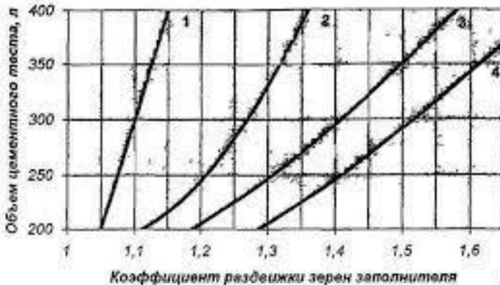
Рисунок 11 – Зависимость коэффициента раздвижки зерен  $\alpha$  от объема цементного теста  $V_{ЦТ}$  на  $1 \text{ м}^3$  бетона (при уменьшении модуля крупности песка  $M_{кр}$  на 1 коэффициент  $\alpha$  уменьшится на  $0,1-0,15$ , однако он не должен быть менее  $1,1$ ):
