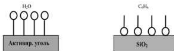
Рисунок 2.30. Ориентация молекул ПАВ на границе раздела: активированный уголь (неполярный адсорбент) – вода (полярный растворитель); силикагель (полярный адсорбент \text{SiO}_2 ) – бензол (неполярный растворитель)
