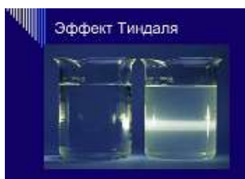
Рисунок 2.39. Светящийся конус в коллоидном растворе
