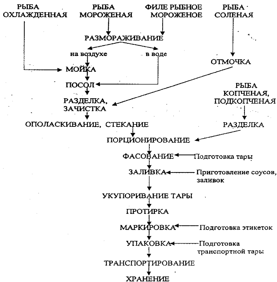
Рисунок 3.1 – Схема технологического процесса изготовления пресервов в соусах и заливках
