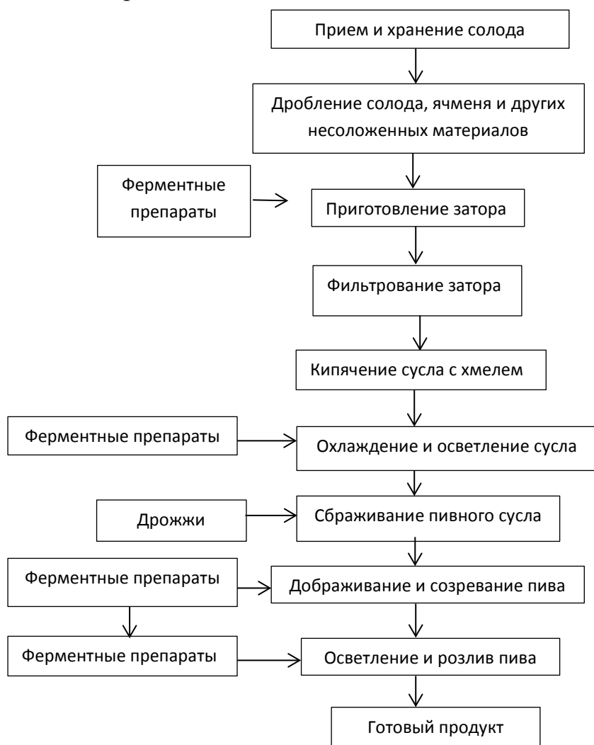
Рисунок 5.1 – Основные стадии технологического процесса производства пива
